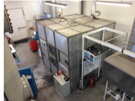
Essai de mesure de la densité des fumées --EN 61034-2 réalisé au caisson de 27m<sup>3</sup>.
