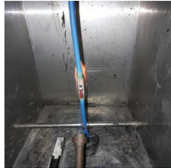
Essai de propagation de flamme sur câbles isolés--EN 60332-1-2 réalisé au brûleur 1kW. Cet essai est le seul à réaliser pour l'Euroclasse E.
