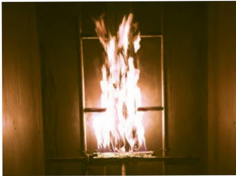
Essai de mesure de chaleur et de fumées dégagées au cours de l'essai de propagation de flamme--EN 50399 réalisé en cabine d'essai «CPR».
